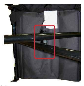
2. Remove the cross brace bolt.
